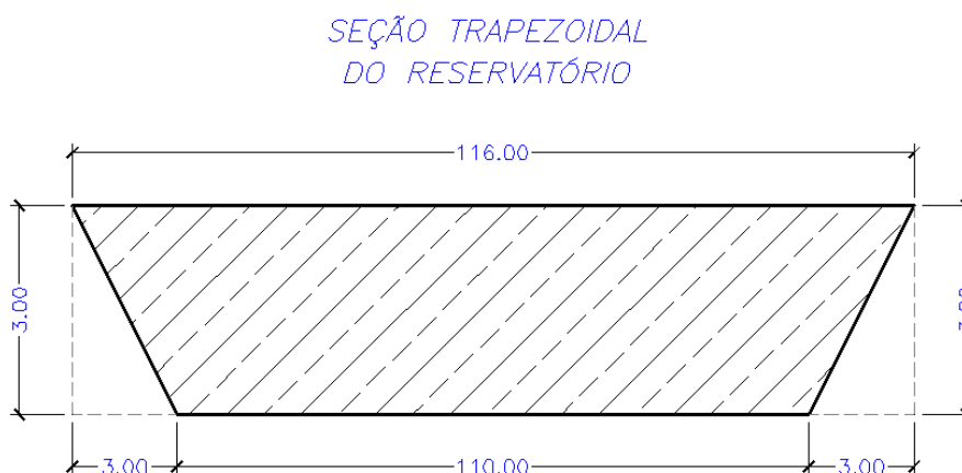
Figura 16 - Seção Trapezoidal do Reservatório
